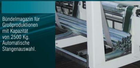
Bündelmagazin für Großproduktionen mit Kapazität von 2500 Kg. Automatische Stangenauswahl.
