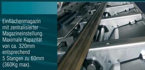
Einflächemagazin mit zentralisierter Magazineinstellung. Maximale Kapazität von ca. 320mm entsprechend 5 Stangen zu 60mm (360Kg max).
