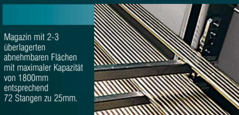
Magazin mit 2-3 überlagerten abnehmbaren Flächen mit maximaler Kapazität von 1800mm entsprechend 72 Stangen zu 25mm.
